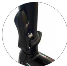
3. Umístěte řídící tyč do svislé polohy, poté řídítka utáhněte pomocí speciální páčky na tyči.
