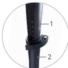
2. Steek het bovenste deel van de stuurpen (aangegeven met nummer 1) in het onderste deel van de stuurpen (aangegeven met nummer 2). Stel de stuurpen in op de hoogte van uw voorkeur.
