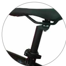
4. Oriente el sillín y apriete correctamente la tija mediante el cierre del cuadro (foto de la derecha). No levante el tubo del sillín más allá del límite **indicado en el vástago del mismo, para evitar que se rompa el cuadro y sufrir lesiones graves mientras conduce.**
