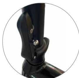
3. Umiestnite riadiacu tyč do zvislej polohy, potom riadič lá utiahnite pomocou špeciálnej páčky na tyči.
