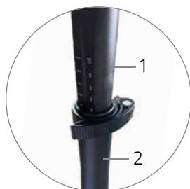
2. Insérez la partie supérieure de la potence de guidon (nommée avec le numéro 1) à l'intérieur de la partie inférieure de la potence de guidon (nommée avec le numéro 2). Ajustez la hauteur de la potence du guidon en fonction de vos préférences de conduite.
