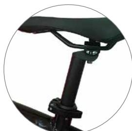
4. Orientez la selle et serrez correctement la tige de selle à travers le collier de selle sur le cadre (photo à droite). **Ne levez pas la tige de selle au-delà de la limite indiquée pour éviter de casser le cadre et des blessures graves lors de la conduite.**
