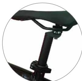
4. Ustaw siodło i prawidłowo dokręć sztycę przez kołnierz siodła na ramie (zdjęcie po prawej). **Nie podnoś rury podsiodłowej poza limit wskazany na sztycy, aby uniknąć złamania ramy i poważnych obrażeń podczas jazdy.**
