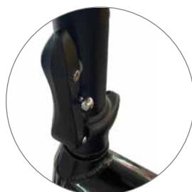
3. Coloque el vástago del manillar en posición vertical, luego apriete el manillar con la palanca correspondiente presente en el vástago.
