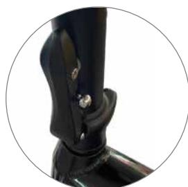
3. Positionnez la potence de guidon en position verticale, puis serrez le guidon à l'aide du levier spécifique sur la potence de guidon.
