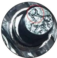
5. Identificare il pedale di destra tramite il marchio R posto sull'asse del pedale, mentre il marchio L identifica il pedale di sinistra.
