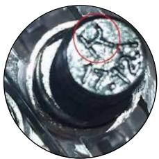
5. Identifique el pedal derecho mediante la marca R colocada en el eje del pedal; por su parte, la marca L identifica el pedal izquierdo.
