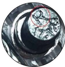
5. Identifikujte pravý pedál pomocí značky R umístěné na ose pedálu, zatímco značka L označuje levý pedál.
