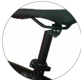
4. Den Sattel ausrichten und die Sattelstütze mit dem Kragen am Rahmen richtig feststellen (Foto rechts). **Das Sattelrohr nicht über den angegebenen Grenzwert anheben, um ein Brechen des Rahmens und schwere Verletzungen während der Fahrt zu vermeiden.**
