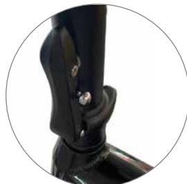
3. Coloque o avanço do guiador na posição vertical, em seguida, aperte o guiador utilizando a alavanca presente no avanço do guiador.
