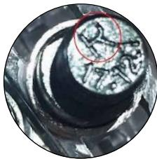
5. Das rechte Pedal wird durch die R-Markierung an der Pedalachse angezeigt, während das linke eine L-Markierung aufweist.
