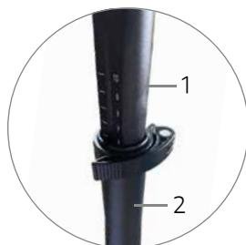
2. Vložte horní část řídící tyče (označeno číslem 1) dovnitř spodní části řídící tyče (označeno číslem 2). Upravte výšku řídící tyče podle svých jízdních preferencí.
