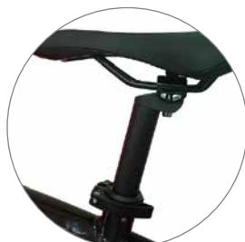
4. Orientare la sella e serrare correttamente il reggisella attraverso il collarino sella presente sul telaio (foto a destra). **Non alzare il tubo sella oltre il limite indicato sul piantone sella per evitare la rottura del telaio e seri infortuni durante la guida.**
