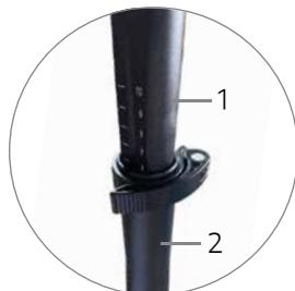
2. Den oberen Teil der Lenksäule (mit der Nummer 1) in den unteren Teil der Lenksäule (mit der Nummer 2) einsetzen. Die Höhe des Lenkers an die Vorlieben beim Fahren anpassen.
